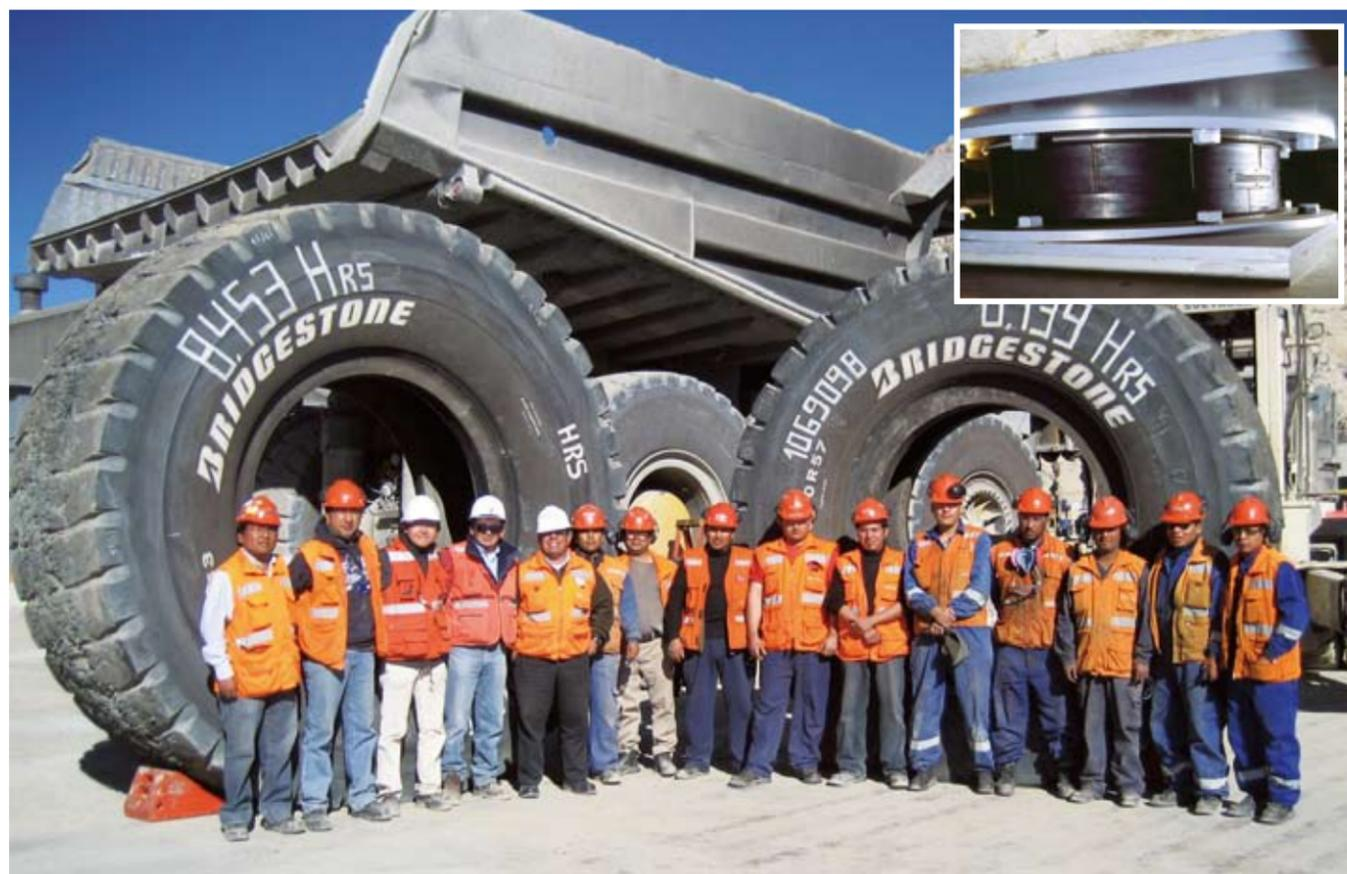
鉱山や採石場で活躍するダンプカーを支える建設・鉱山車両用タイヤ。最大で直径4メートルになる / (右上) 地震による建物の損傷を防ぐだけでなく、人々の暮らしや経済活動の維持・継続に貢献する免震ゴム
